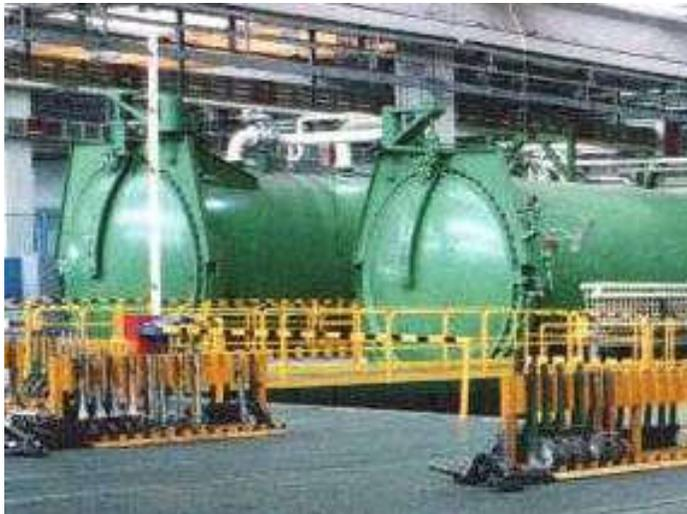
Il ciclo di cura viene ottimizzato in funzione dei parametri ricavati dalla curva di viscosità della resina ( $\eta_{\min}$ ,  $t_{\text{gel}}$ )
